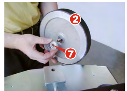
Placer des ENTRETOISES supplémentaires en dessous et reserrer le DISQUE DE CINTRAGE.
