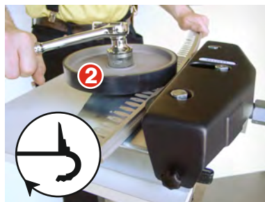
Faire glisser le profilé FLORENTOSTEP après l'avoir retourné. Tourner le DISQUE DE CINTRAGE en utilisant le cliquet pour faire avancer le profilé.
